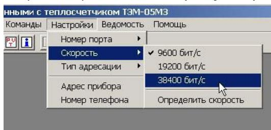
Настройку скорости обмена данными для работы с вновь подключенным прибором можно начинать с выполнения команды **Определить скорость**. В этом режиме компьютер последовательно переберет все скорости и установит у себя скорость, соответствующую скорости теплосчетчика. Для правильного определения скорости необходимо чтобы прибор был подключен к тому последовательному порту компьютера, на который настроена программа.
