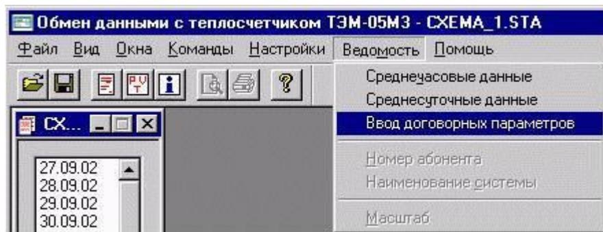
Выполнение команды **Ввод договорных параметров** вызывает окно диалога, в котором можно осуществить предварительную установку договорных параметров теплопотребления для расчёта потреблённого тепла в соответствии с временной инструкцией **ГУП "Мосгортепло" от 2001 г.**
