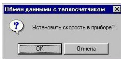
в котором нажатие клавиши **OK** установит новую скорость обмена в теплосчетчике и компьютере, а нажатие клавиши **ОТМЕНА** – только в компьютере (при этом, для установления соединения, скорость обмена в теплосчетчике придется устанавливать вручную с помощью клавиатуры прибора).
