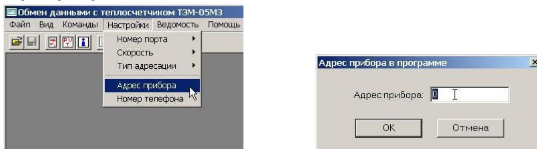
При чтении данных через интерфейс RS-485 (с использованием специального конвертера) существует возможность чтения информации из нескольких приборов, объединенных в сеть. Для выбора определенного теплосчетчика в сети необходимо установить в программе его сетевой адрес. При работе через интерфейс RS-232C адрес прибора должен быть установлен в 0.
