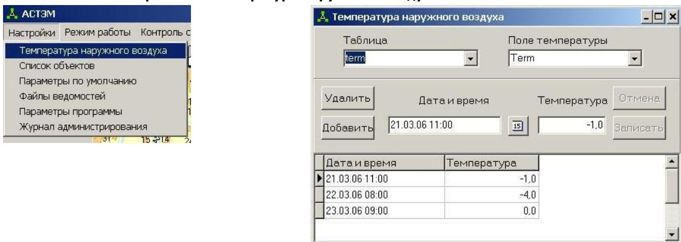
В качестве температуры наружного воздуха могут быть использованы значения, вводимы вручную или значения, измеряемые любым термопреобразователем в одной из систем.
