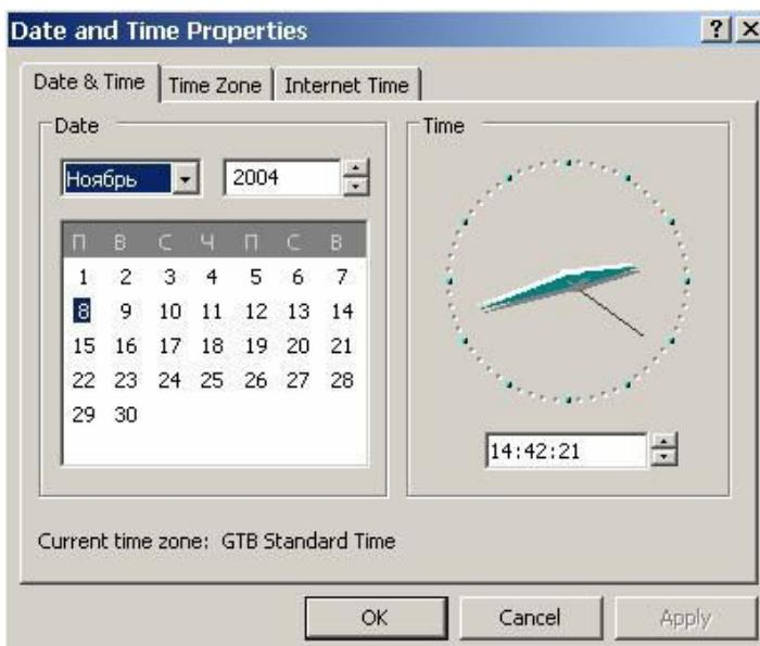
В появившемся окне нужно набрать нужное время (поле под стрелочными часами), и в момент последнего сигнала точного времени нажать кнопку **OK**.
