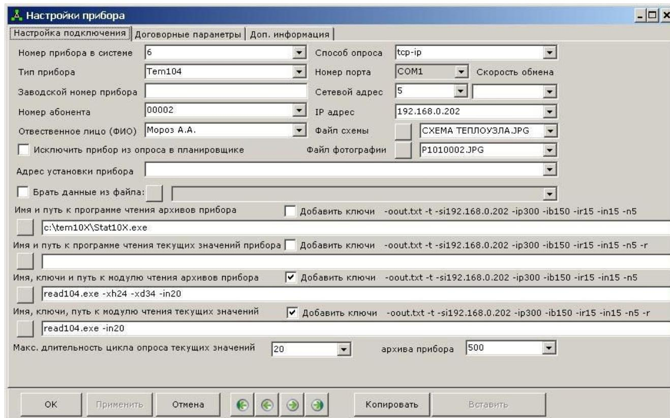
На закладке **Настройка подключения** автоматически устанавливается номер прибора в сети и тип объекта. Дополнительно необходимо указать:
