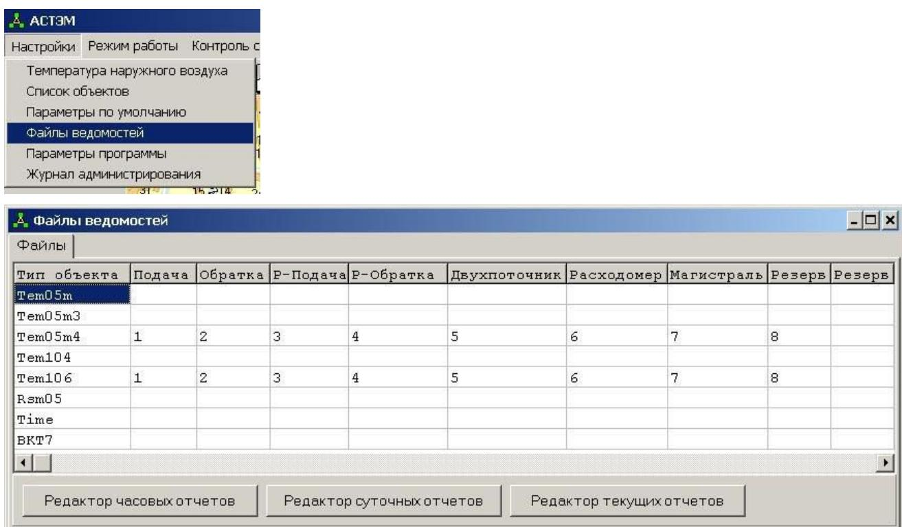
В этом окне нужно настроить имена файлов шаблонов отчетов, которые будут использоваться при формировании отчетов для каждого типа теплосчетчика и каждой системы.
